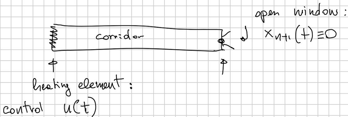
$$\frac{\partial}{\partial t} \begin{bmatrix} x_1(t) \\ x_2(t) \\ \vdots \\ x_n(t) \end{bmatrix} = \frac{\alpha}{n^2} \underbrace{\begin{bmatrix} -2 & 1 & & & 0 \\ 1 & -2 & 1 & & \\ & 1 & -2 & 1 & \\ & & & \ddots & \ddots \\ 0 & & & & 1 & -2 \end{bmatrix}}_A \cdot \begin{bmatrix} x_1 \\ x_2 \\ \vdots \\ x_n \end{bmatrix} + \underbrace{\begin{bmatrix} 1 \\ 0 \\ 0 \\ \vdots \\ 0 \end{bmatrix}}_B u(t)$$
